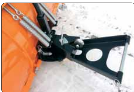
Kladka pro připojení navijáku, zdvojené odpružení pozinkovanými pružinami.
